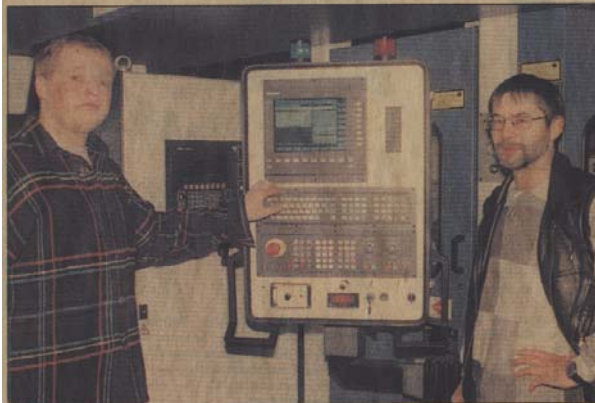
Die BEIDEN Geschäftsführer Ulrich Düser (links) und Wolfgang Peuker vor ihrer CNC-gesteuerten Laser-Maschine, mit der Rohre paßgenau geschnitten werden. Fotos: Patzer
